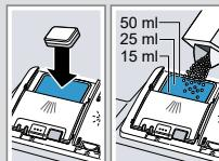
2. Den Deckel der Reinigerkammer schließen.
