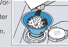
3. Das Spezialsalz in den Vorratsbehälter füllen. Das Wasser im Vorratsbehälter wird verdrängt und läuft ab. Nie Reiniger einfüllen.
